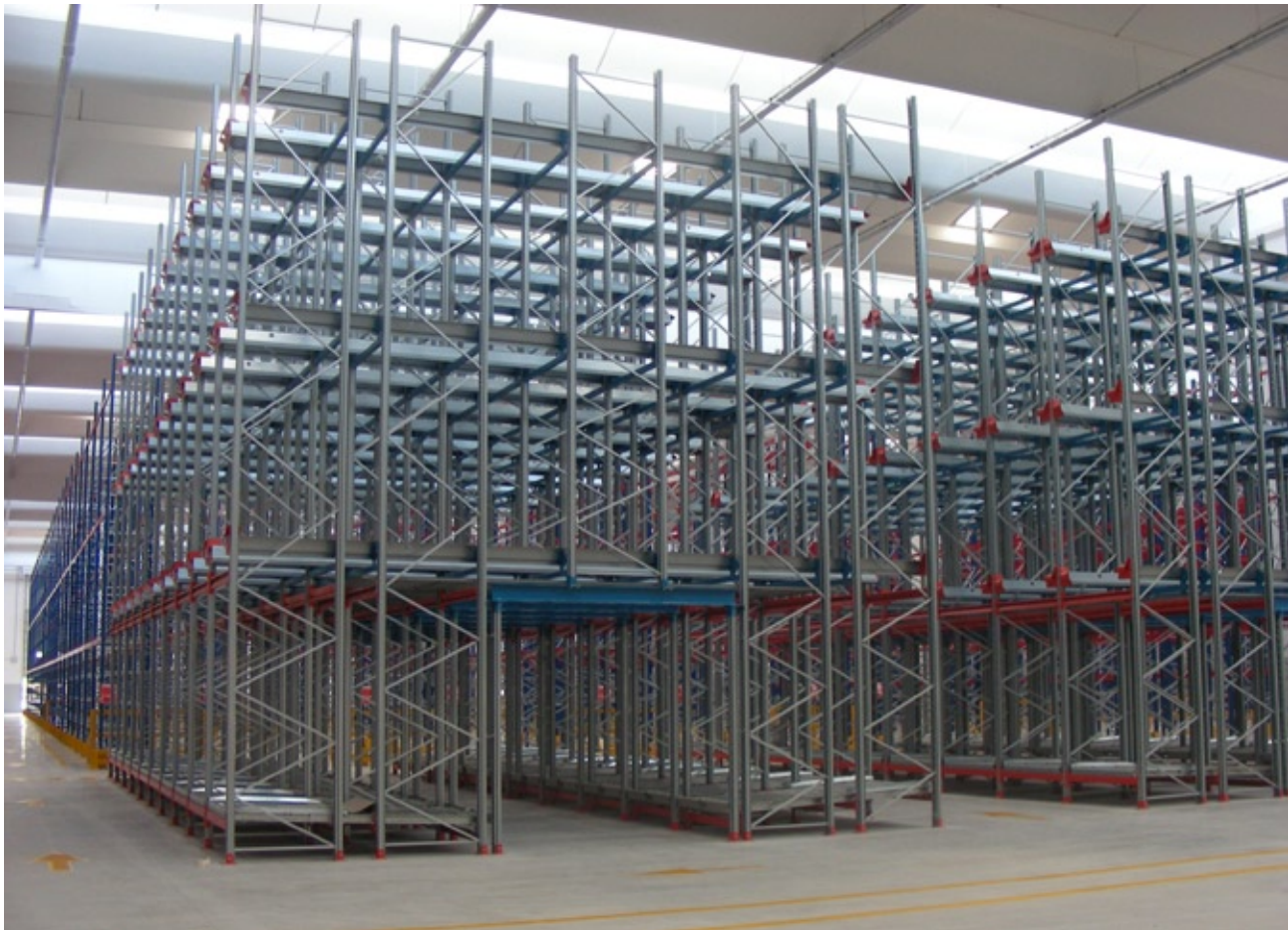
Sistema ad accumulo massivo (radioshuttle)
